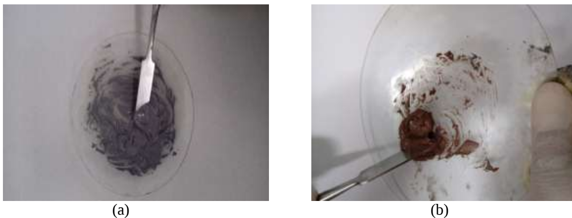
Figura 2. (a) adesivo puro (b) adesivo compósito com 15% de cobre
