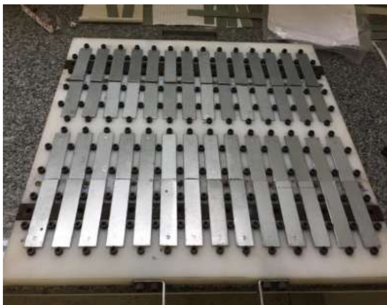
Figura 3. Dispositivo que controla a espessura da camada colada
