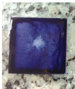
Figura 2: Fotografia do fotoanodo sensibilizado com o corante extraído da Thunbergia erecta .
