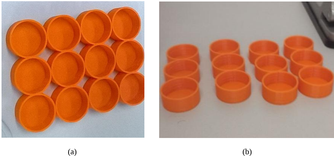
Figura 2. Moldes confeccionados na impressora 3D. (a) Vista superior. (b) Vista lateral
