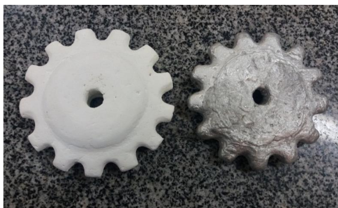
Figura 2: Modelo de poliestireno (esquerda) e peça fundida de alumínio (direita).
