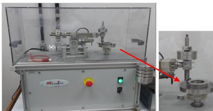
Figura 4. Tribômetro e montagem utilizada no ensaio pino sobre disco.
