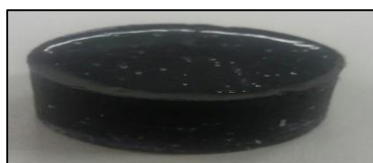
Figura 4: Corpo de prova desmoldado após a cura.
