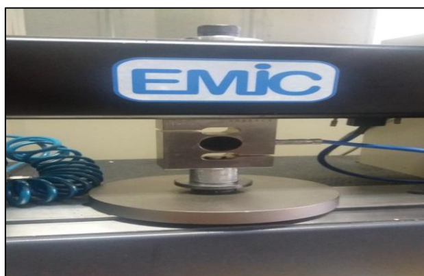
Figura 5: Posicionamento dos Cp's de forma correta para o ensaio de compressão.
