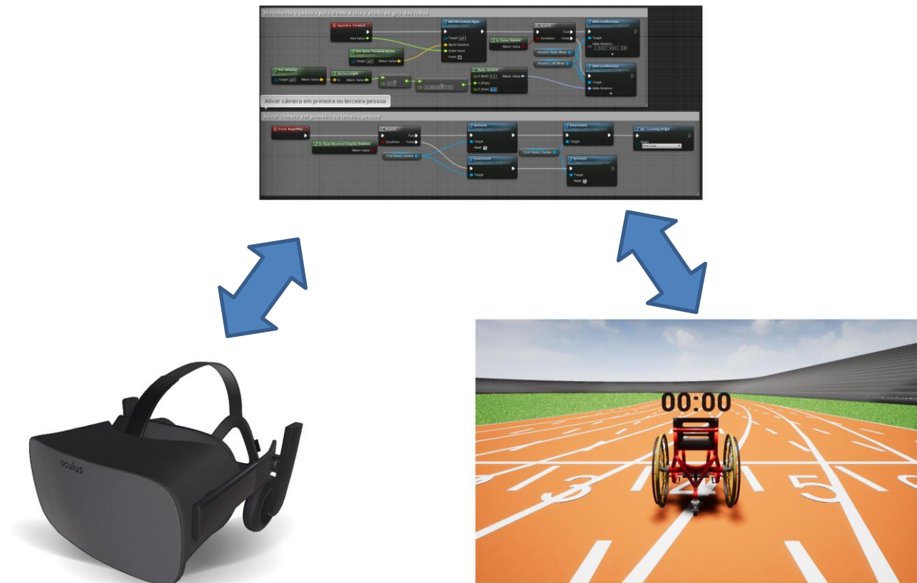
Figura 2. Exemplo da programação em blocos e troca de informações entre os óculos de realidade virtual e o ambiente virtual com seus objetos.
