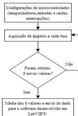
Figura 2. Fluxograma do programa na plataforma Arduino, Acervo Pessoal (2017).
