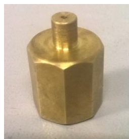
(b) – Tubo capilar com orifício calibrado.
