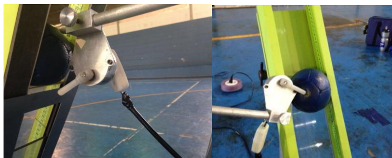
Figura 4. Dispositivo eletrônico que simula o lançamento do atleta
