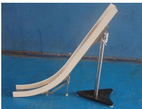
Figura 1. Calha de bocha paralímpica feita de acrílico e laterais de madeira com pedestal em aço.
