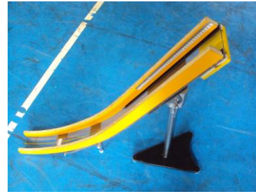
b) Calha de madeira e acrílico
