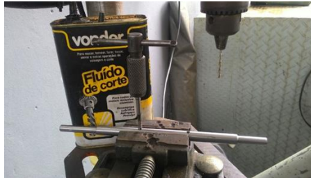
Figura 7. Eixo em processo de furação para fixação das abraçadeiras.
