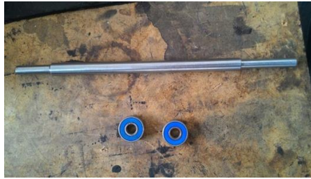
Figura 6. Eixo usinado e rolamentos utilizados.
