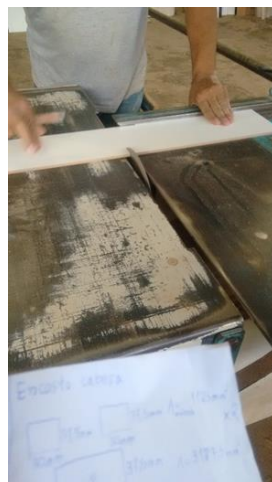
Figura 2. Corte da madeira na esquadrejadeira de serra circular.
