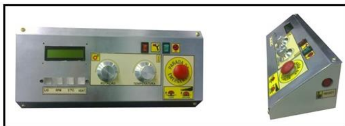
Figura 1. Painel de comandos (vista frontal e lateral).
