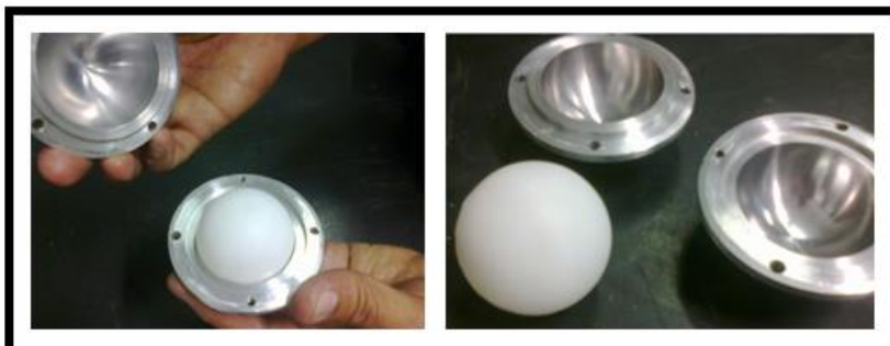
Figura14. Peça rotomoldada em PEAD com relação 1:4.
