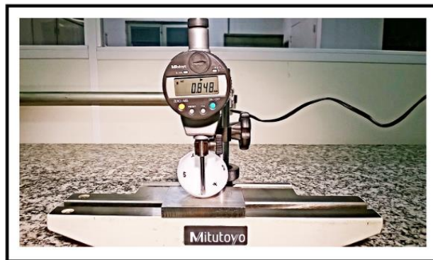
Figura17. Corte da peça e Medição com Relógio comparador digital.
