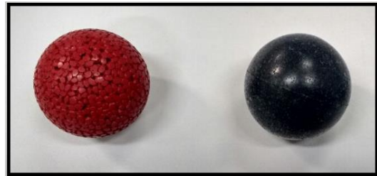
Figura 16. Peça rotomoldada em pellets e polietileno com negro de fumo.
