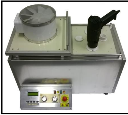
Figura 12. Soprador acoplado na tampa.
