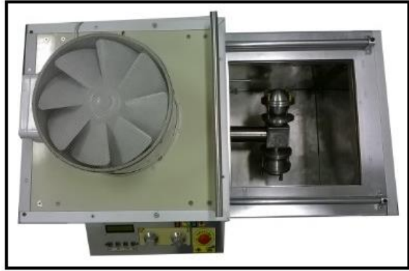
Figura 13. Câmara de aquecimento aberta.
