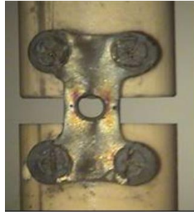
Figura 7. Placa H de titânio com carregamento de 300N (compressão)
