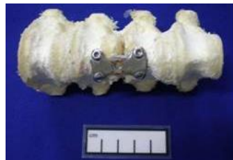
Figura 2. Modelo experimental com a placa de aço inoxidável fixado no segmento vertebral
