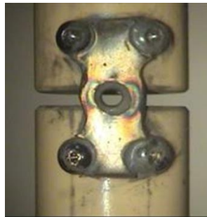
Figura 5. Placa H de aço inoxidável com carregamento de 300N (compressão)
