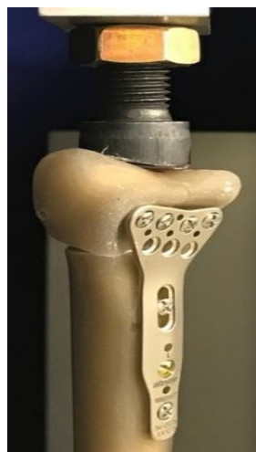
Figura 5. Ensaio de compressão axial. Fonte TUF1 2017
