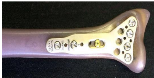
Figura 1. Conjunto montado Osso sintético com Placa e Parafusos. Fonte: TUFÍ, 2017
