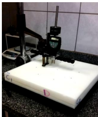
Figura 1: Avaliação da dureza em nove pontos de medida, LPM. Uberlândia (MG), 2017.
