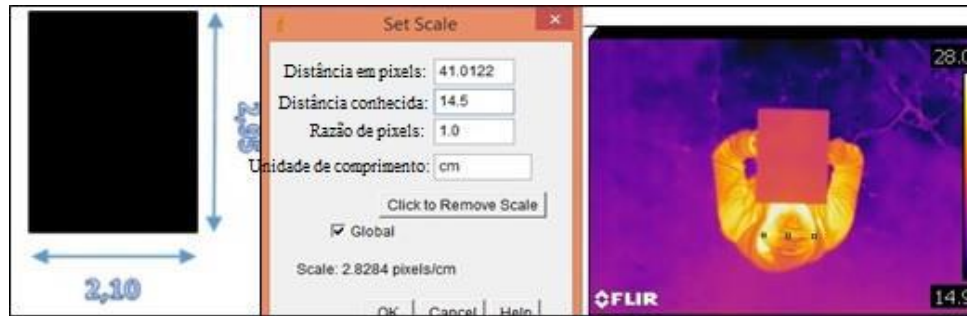
Figura 1. Calibração da escala nas imagens, valores em cm, com o software ImageJ.
