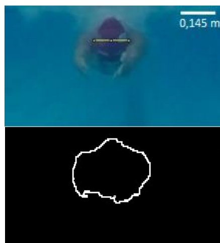
Figura 2. Extração de contorno com o software ImageJ, a partir de imagem original.
