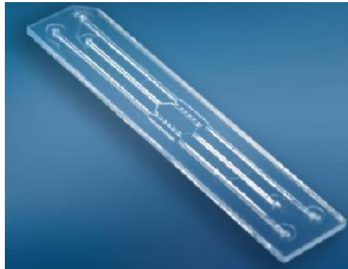
Figura 1. Exemplo de um “Chip”, dispositivo para realização de experimentos em microfluídica, BE-GRADIENTE - Beonchip.
