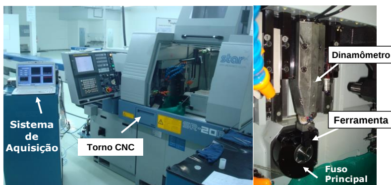
Figura 2. Montagem experimental para os ensaios de roscamento e medição da força de corte.
